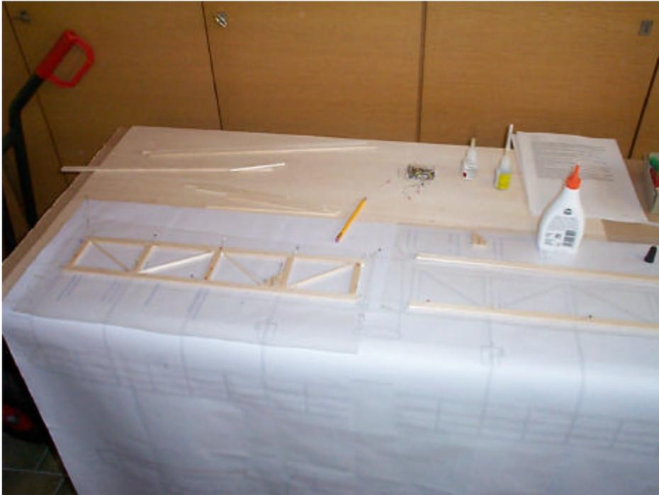
Schlitz für Ruderhorn (39) kontrollieren –es wird nach dem Bespannen eingeklebt.
