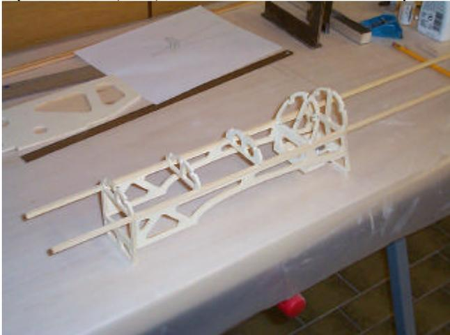
Anfertigen einer Helling zum weiteren Bau des Rumpfes gemäß Zeichnung Rumpfgurte Seite auf Helling ausrichten und befestigen. Dann Spanten S7, S8, S9 und S10 anbringen.
