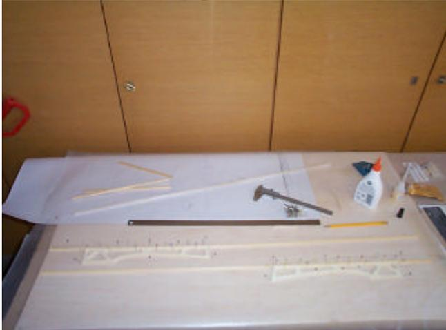
Mit den Spanten S2, S5a, S6a, dem Auflagebrettchen Tragfläche (20) und den vorbereiteten Rumpfseitenteilen einen Kasten gem. Bauplan verleimen. Auf Winkligkeit achten.
