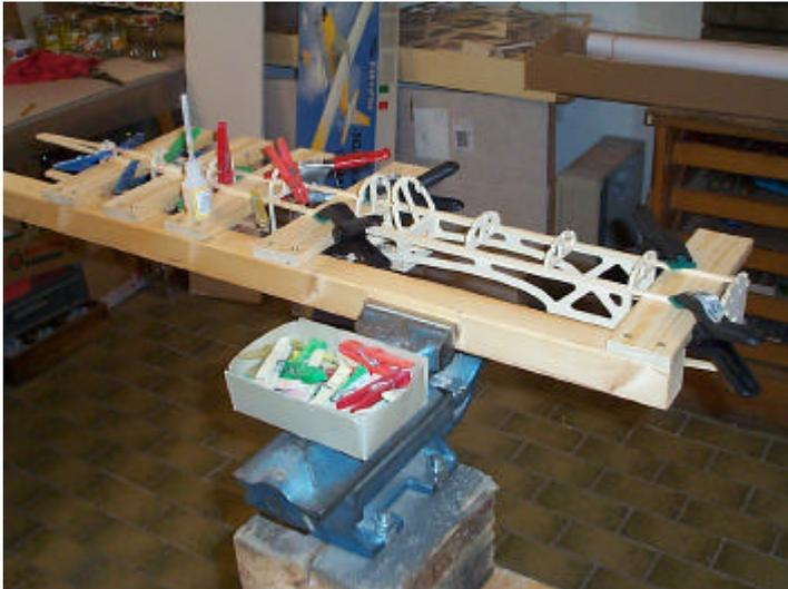
Stabilisierungsflossen und Ruderblätter für das Leitwerk aus dem Auflagebrett (36) und den Leisten 34, 35, und 37 auf dem Bauplan aufbauen.
